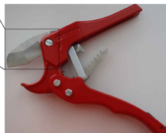
Profesjonalne nożyce z ostrzem w kształcie V. Do cięcia używaj zawsze ostrych nożyc.
