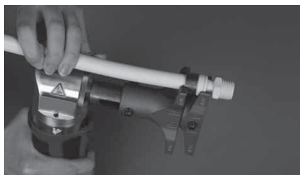
6. Stlačte do konce, čelist se vrátí do výchozí startovací polohy.
