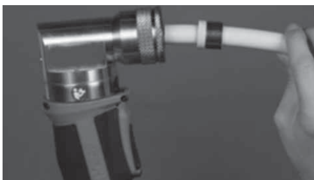
3. Vložte roztažný nástroj do potrubí a roztáhněte. Pootočte a roztáhněte zbytek obvodu. (použití nástroje s roztažnou čelistí o velikosti zpracovaného průměru trubky)
