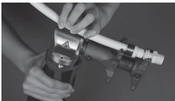
5. Přiložte lisovací nářadí k tvarovce potrubí a zalisujte kroužek.
