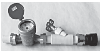
obr. 24: Ukázka praktického použití rozebíratelných spojů – připojení rozvodu vody z polypropylenu typu 3 (vodoměr + ventil se zpětnou klapkou) rod. domku (bytu) k centrálnímu rozvodu vody z rPE.
